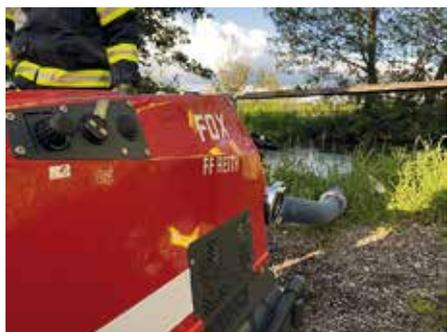
Zumal wurde das Gesamtgewicht der Tragkraftspritze (TS) auf 166 kg reduziert, eine starke Beleuchtung für nächtliche Einsätze wurde eingebaut und die Handhabung erfolgt hauptsächlich über ein Bedienfeld. Somit ist die Wasserversorgung gesichert und auf dem neuesten Stand!
